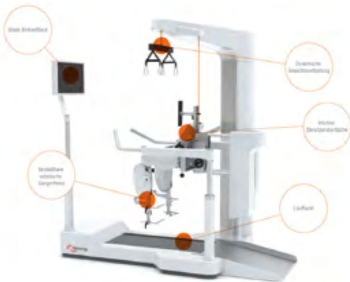
Der Lokomat ist ein computergesteuertes Exoskelett in Kombination mit einem Laufband.
